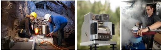
Das BFO ist mit über 30 Sensoren ausgerüstet, unter anderem STS-1 und STS-2 Breitband-Seismometer, Supraleitendes Gravimeter, Federgravimeter, Extensometer, Neigungsmesser, permanentes GPS, Magnetometer, Infraschallsensor, Luftdrucksensor-Array sowie diverse meteorologische Messinstrumente. Damit besitzt das BFO die notwendige instrumentelle Ausstattung, um die folgenden Beobachtungsgrößen redundant und mit größtmöglicher Empfindlichkeit zu erfassen:
