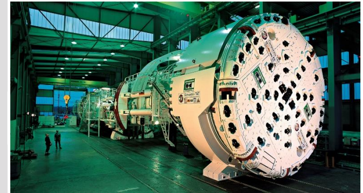
Gripper-TBM von Herrenknecht für den Gotthard-Basistunnel, Schweiz, Ø 8.830 mm (Bild: www.herrenknecht.com)
